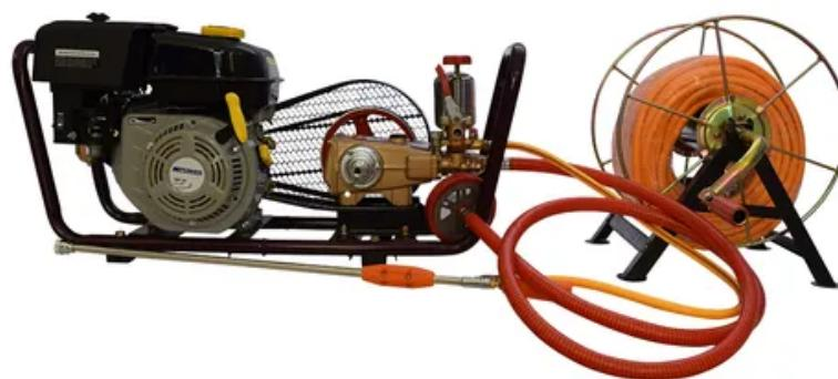
**La Parihuela MPOWER con motor de 6.5 HP es una herramienta robusta diseñada para fumigación agrícola de gran alcance. Su motor de gasolina brinda potencia constante y eficiencia en el bombeo de líquidos.**
