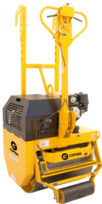
Este rodillo vibratorio de un solo tambor está diseñado para la compactación eficiente de bases granulares, suelos cohesivos o mixtos, tanto en proyectos de mediano a gran tamaño como para labores de bacheo, caminos, estacionamientos y almacenes
