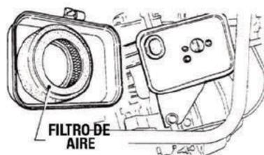
El filtro de aire ubicado del lado del motor, se ensucia mucho, por lo tanto, sumérgalo en una mezcla de 3 partes de gasolina y 1 parte de aceite. Posteriormente apriete el elemento filtro de aire (esponja) y sacuda bien el interior del filtro secundario antes de reinstalarlo.
